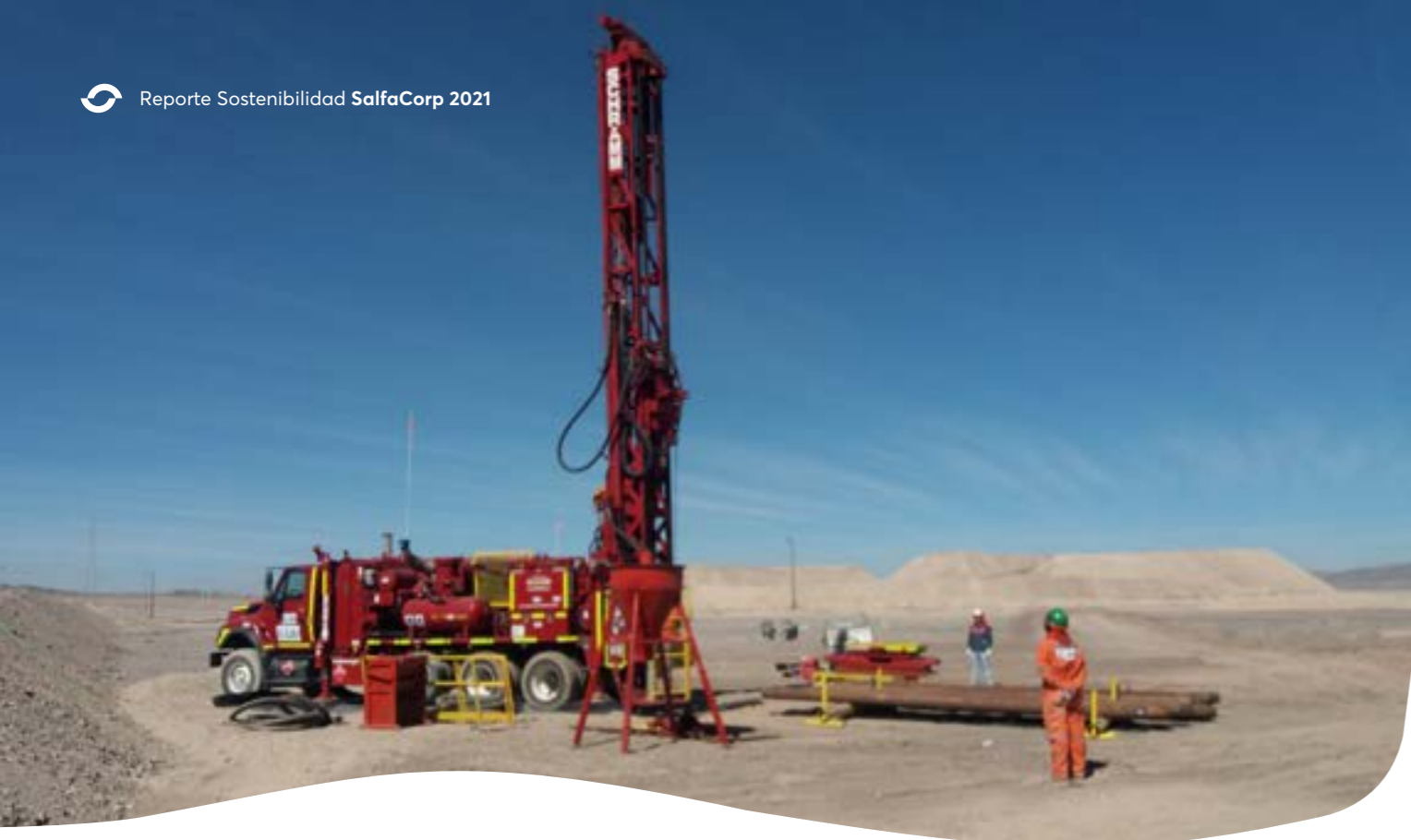
BHP / Spence, Servicio de Perforación de Sondajes Hidrogeológicos y Geotécnicos, Calama, II Región, Chile.
